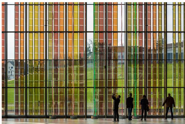
Abbildung 15: Ein Gebäude der Ecole Polytechnique Lausanne mit einer Fassade aus Grätzel-Zellen<sup>32</sup>
